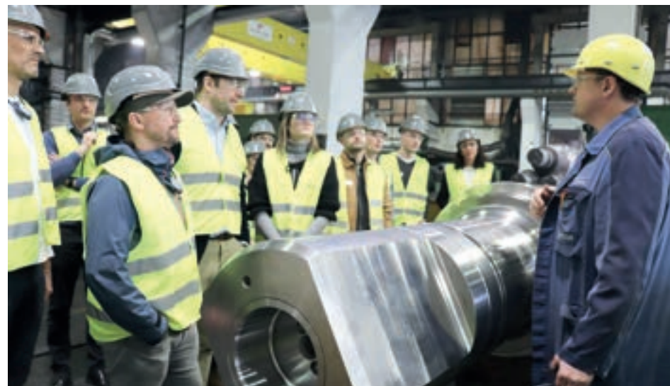
Imposante Verbundgusswalzen in der Gießerei des ESW.
